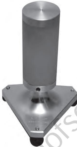
Prüfkörper bestehend aus PE, Shore-Härte 80, nominalen Durchmesser von 53,5 mm.
