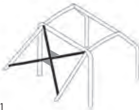
Zeichnung 253-21 (mit Knotenblechen), die Knotenbleche dürfen statt oben und unten auch links und rechts angeordnet sein
