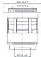
Zeichnung 252-5 Version B Kupplungsdose
